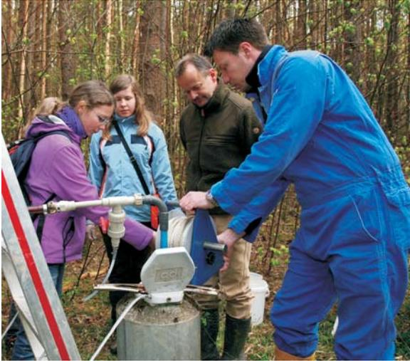
*Messung des Grundwasserstandes mittels Lichtlot,
