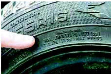
Auf jedem Reifen wird der maximale Reifendruck angegeben
